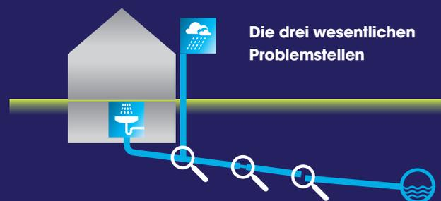
Dazu werden alle Abwasserleitungen mit Kameras befahren und gegebenenfalls Druckuntersuchungen oder Farbtests vorgenommen. Auch achten wir auf die Einhaltung des Trennsystems von Schmutz- und Niederschlagswasser. Außerdem suchen wir nach eindringendem Wasser und überprüfen vorhandene Drainagen. Insgesamt muss je nach Grundstücksgröße und Umfang der Abwasseranlage mit einem Untersuchungszeitraum von einem Tag gerechnet werden.
