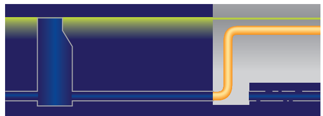
Abhängung neuer Leitungen im Kellerbereich
