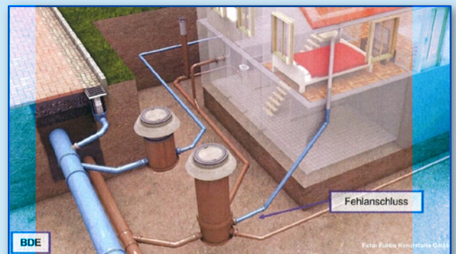
Falsche Anbindung der Niederschlagswasserleitungen
